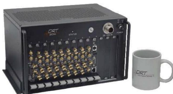
图 7-3 Dirtbox（DRT 2101A）伪基站
